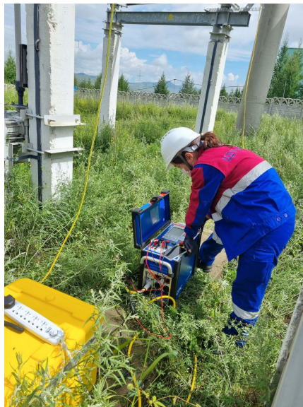
OMICRON CPC-100 багажаар хэмжилт хийх явц
